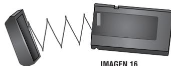
7. Coloque los montantes del fondo de la caja del cargador en la última bobina del resorte del cargador.
